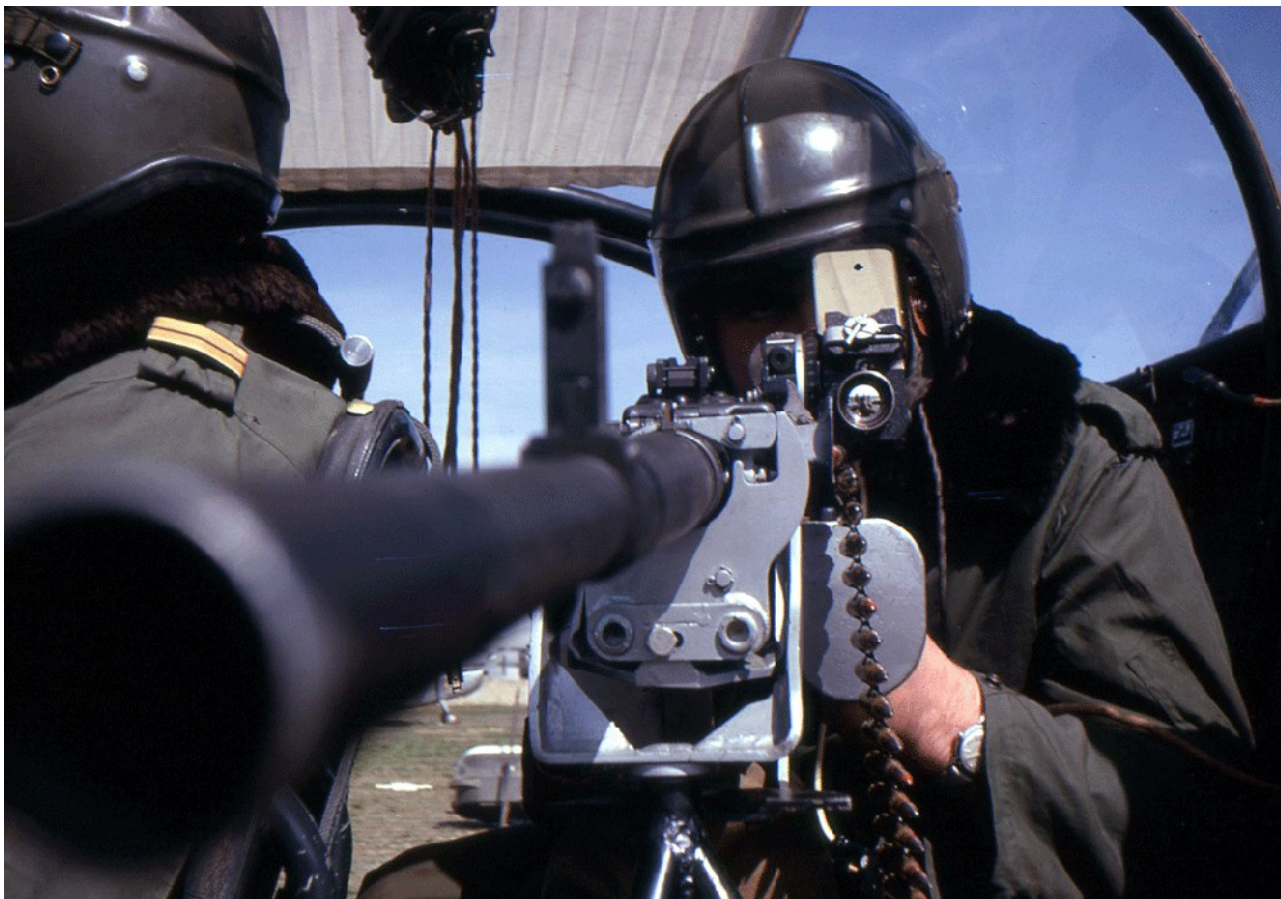
L'Alouette II n° 1297, codée BNM, équipée d'une mitrailleuse AA52 monté sur un affût de T-6 bricolé.
